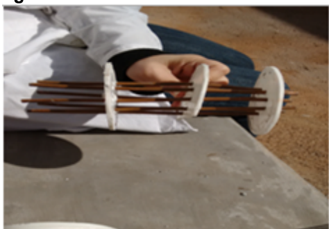
Figura 5 – Chicanas e tubos de cobre
