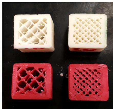
As amostras foram submetidas ao ensaio de compressão utilizando a mesma máquina universal de ensaios. Para a obtenção das forças exercidas, foi utilizada uma célula de carga com capacidade máxima de 4905N e as deformações foram captadas pelos sensores internos de deslocamento da máquina. A prova foi colocada entre duas placas e foi aplicada uma força vertical na direção do plano tangente às camadas, na velocidade de 1 mm/min (**Figura 7**).
