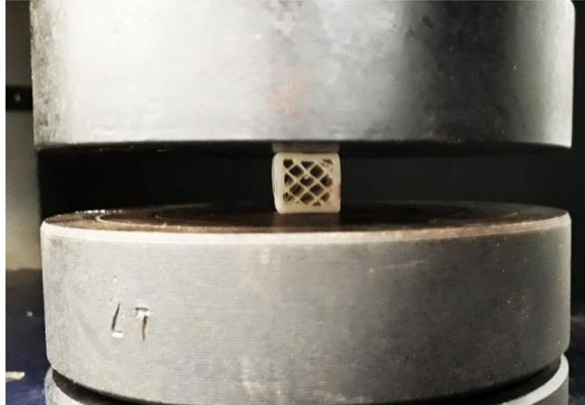
A partir dos ensaios de compressão foram obtidas curvas de força (N) x deformação (mm). Como a área de aplicação da força não é conhecida devido a direção do carregamento e da porcentagem de preenchimento das camadas, também não foi possível trabalhar com a tensão.
