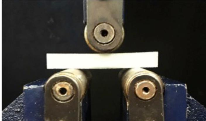
A partir dos ensaios mecânicos de flexão em três pontos foram obtidas curvas de força (N) x deformação (mm). Como os corpos de provas não foram fabricados com 100% de preenchimento, não foi possível calcular o momento de inércia das amostras e assim impedindo de trabalhar com o parâmetro de tensão. Além disso, o mesmo motivo inviabiliza padronizar os testes realizados de acordo com as normas da literatura, as quais tratam de corpos de prova homogêneos com 100% de preenchimento.
