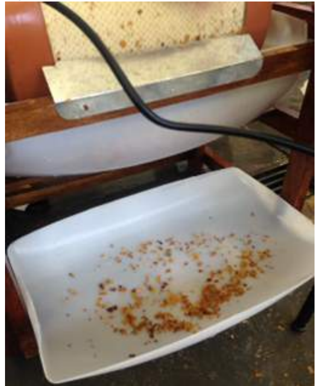
Figura 25. Coleta da torta após passar pelo raspador
