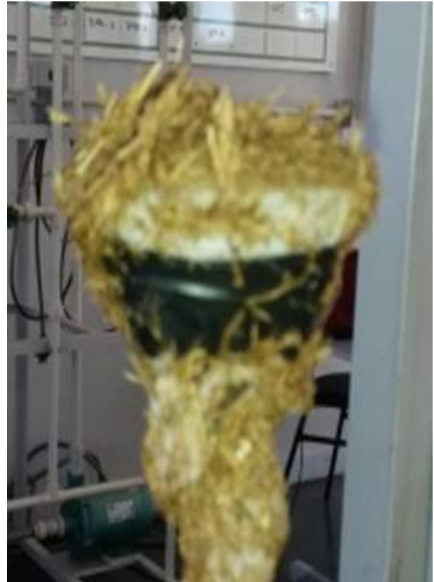
Figura 22. Torta formada no teste 1
