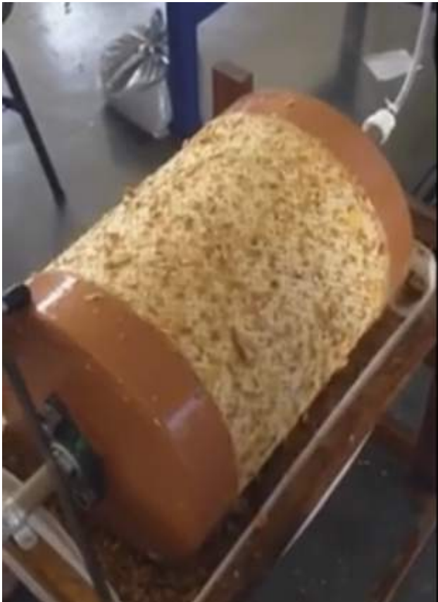
Figura 24. Formação de torta na superfície do filtro de tambor rotativo à vácuo
