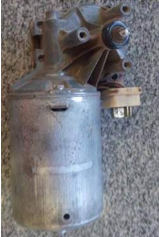
Figura 9. Motor utilizado para rotacionar o tambor do filtro.
