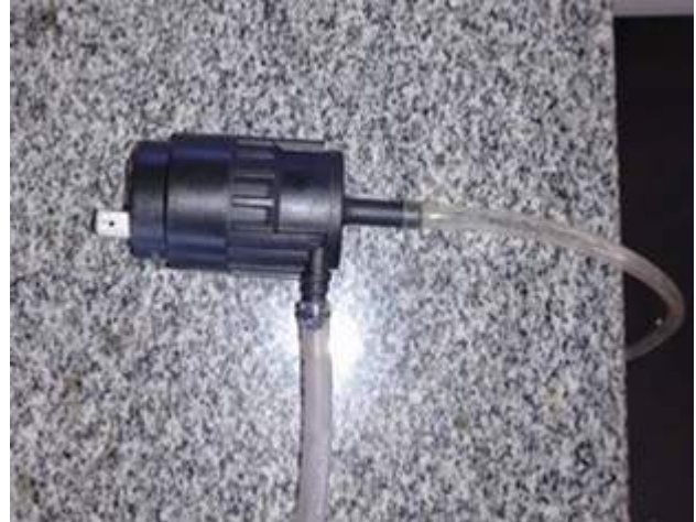
Figura 11. Bomba utilizada na sucção de filtrado do interior do filtro.
