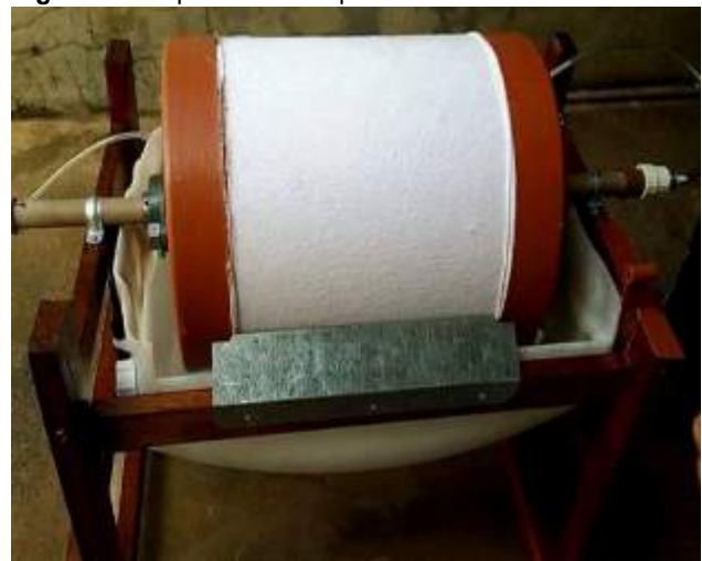
Figura 21. Suporte com raspador e acessórios.
