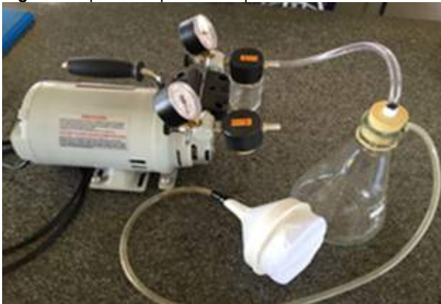
Figura 8. Aparato experimental para o teste do filtro folha
