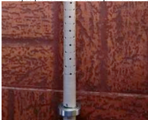
Figura 17. Disposição dos furos na tubulação fixa de PVC 1"
