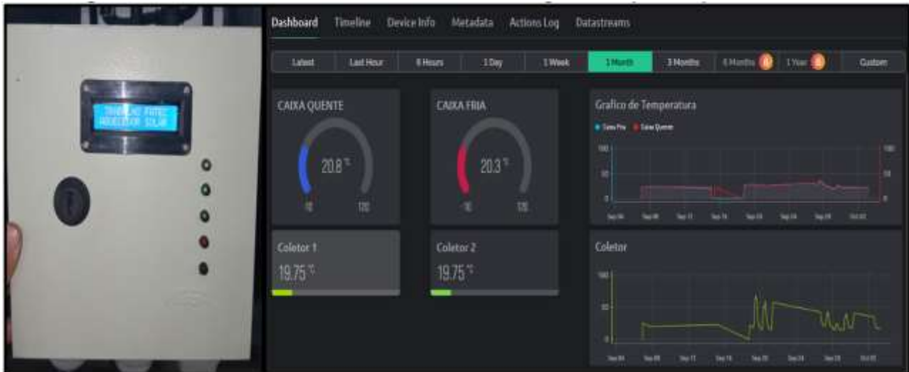
Figura 2 - Monitoramento e controle dos dados gerados pelo aquecedor solar.
