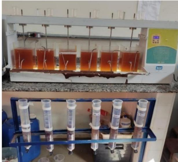
Após 3 minutos de sedimentação, coletou-se as amostras em cada um dos jarros e realizou-se análises de pH, condutividade elétrica, turbidez e cor aparente. Este procedimento foi repetido a cada 10 minutos, sendo a última amostragem com 33 minutos, com o objetivo de avaliar a eficiência de cada um dos coagulantes.
