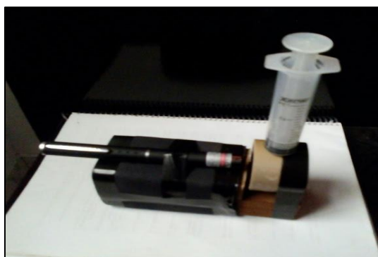
Figura 9: Microscópio alternativo usando laser e seringa.
